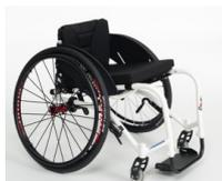
Ce fauteuil actif possède un dossier rabattable sur l'avant, réglable en inclinaison (de -7° à +7°) et en hauteur. La toile du dossier et de l'assise sont réglables en tension. Le fauteuil est équipé d'une barre de poussée et d'un blocage du dossier en position rabattue, ce qui en fait un actif complet et pratique. Disponible également en version assise inclinable et réglable en angle.
