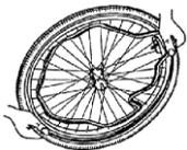
Schieben Sie den Reifen über den Rand der Felge und beginnen Sie hinter dem Luftventil. Pumpen Sie den Schlauch leicht auf, bis er rund ist, und legen Sie ihn in den Reifen.
