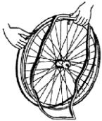
Platzieren Sie den Felgengurt über dem Luftventil, bevor Sie ihn in die Felge einsetzen. Der Felgengurt kann jetzt leicht übergezogen werden. Stellen Sie sicher, dass alle Speichenköpfe abgedeckt sind (bei Kunststoffrand ist kein Felgengurt erforderlich).
