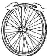
Wenn der Schlauch ohne Falten in den Reifen passt (bei Falten: lassen Sie etwas Luft heraus), kann beginnend am Luftventil die Oberseite des Reifens mit beiden Händen leicht an die Felge gedrückt werden. Drücken Sie das Luftventil leicht nach innen und ziehen Sie es erneut heraus, um sicherzustellen, dass der Reifen richtig im Bereich des Luftventils positioniert ist.
