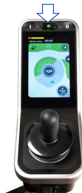
Figure 2 Mise en marche et arrêt
