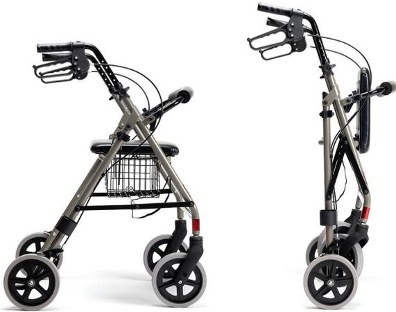
Der **Eco-Light II** ist ein faltbarer 4-Rad-Rollator. Er ist mit einem abnehmbaren Korb, einem gepolsterten Sitz und einem Krückenhalter ausgestattet. Eine klappbare Stange bietet zusätzlichen Halt beim Sitzen. Bestückt mit Feststellbremsen und höhenverstellbaren Griffen. Zusammenklappbar und sekundenschnell transportbereit.
