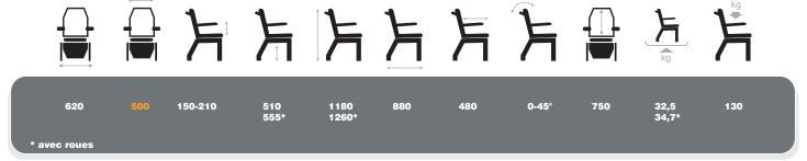
Photo non-cantractuelle. Dimensions en mm, poids en kg. Tolérances dimensionnelles et pondérales admises : 15 mm, 1,5 kg et 1,5°.
